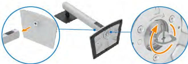
6. Otevřete ochranný kryt pro přístup k otvoru VESA na displeji.
