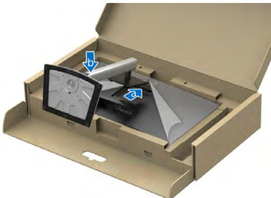
8. Držte podstavec oběma rukama pevně a zvedněte monitor. Potom umístěte monitor do vzpřímené polohy na rovný povrch.
