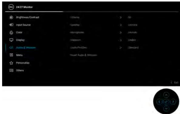
**POZNÁMKA:** Aby webová kamera a mikrofon fungovaly, připojte výstupní kabel USB z počítače k monitoru.
