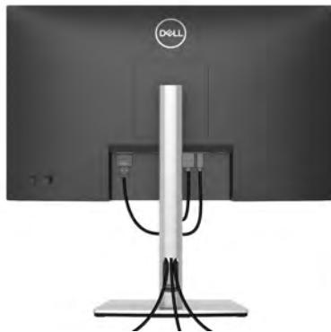
Po připojení všech kabelů k monitoru a počítači (viz část [Připojení monitoru](#)) uspořádejte kably výše uvedeným způsobem.
