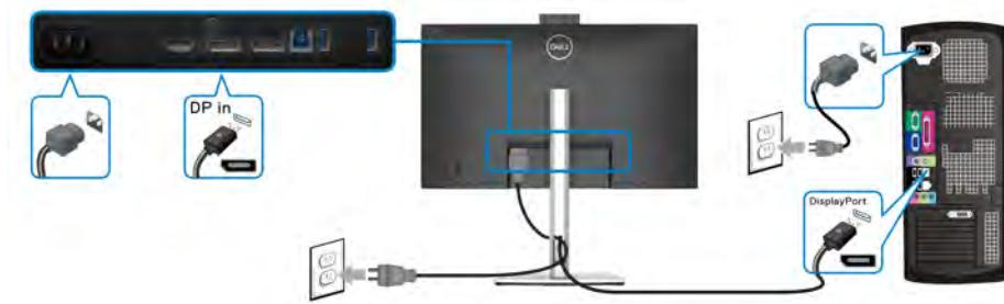
**POZNÁMKA:** Výchozí tovární nastavení je DP1.2. Pokud monitor nezobrazí obsah po zapojení kabelu DisplayPort, postupujte podle kroků níže a změňte nastavení na DP1.1:
