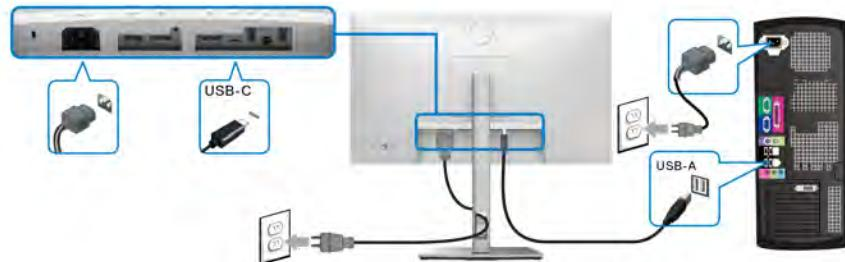
**POZNÁMKA:** Stolní počítač umístěte nalevo od monitoru (při pohledu zpředu), aby bylo zapojení kabelu USB-C na USB-A jednodušší. Pokud to délka kabelu neumožňuje, neveděte kabel otvorem ve stojanu monitoru.
